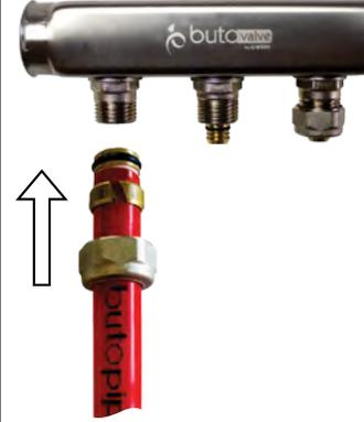
**5. Kollektör çıkışının altıgen kısmını, ayarlanabilir bir anahtarla tutarken, sıkıştırma somununu yarım turdan fazla olmayacak şekilde 2. bir anahtar yardımıyla elle sıkınız.** (While holding the hex end of the manifold outlet with an adjustable wrench, turn the compression nut with a second wrench no more than a half turn beyond hand tight.)
