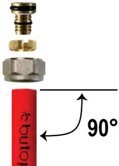
**2. Sıkıştırma somununu ve yüksüğü boruya geçiriniz. Sonrasında iç bağlantı elemanını, borunun üst kısmına oturuncaya dek borunun içine bastırınız.** (Slide the compression nut and split ring over the pipe. Then push in the insert fitting all the way to the top of the pipe.)
